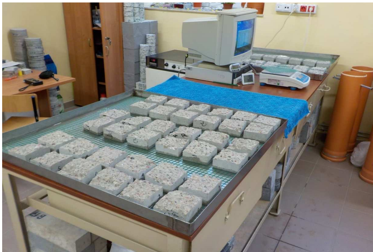
Rysunek 5. Badanie sorpcyjności betonu [124]
