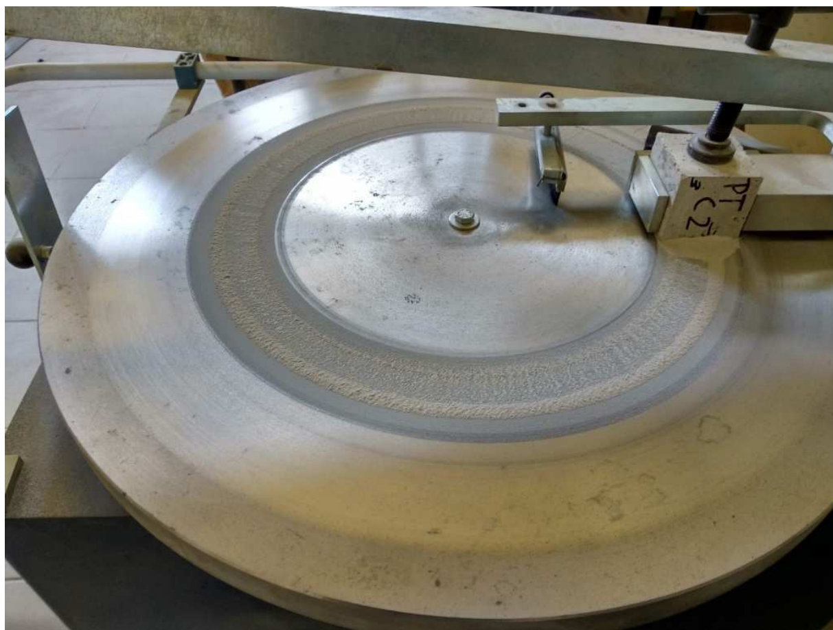
Rysunek 7. Badanie ścieralności na tarczy Boehmego [124]
