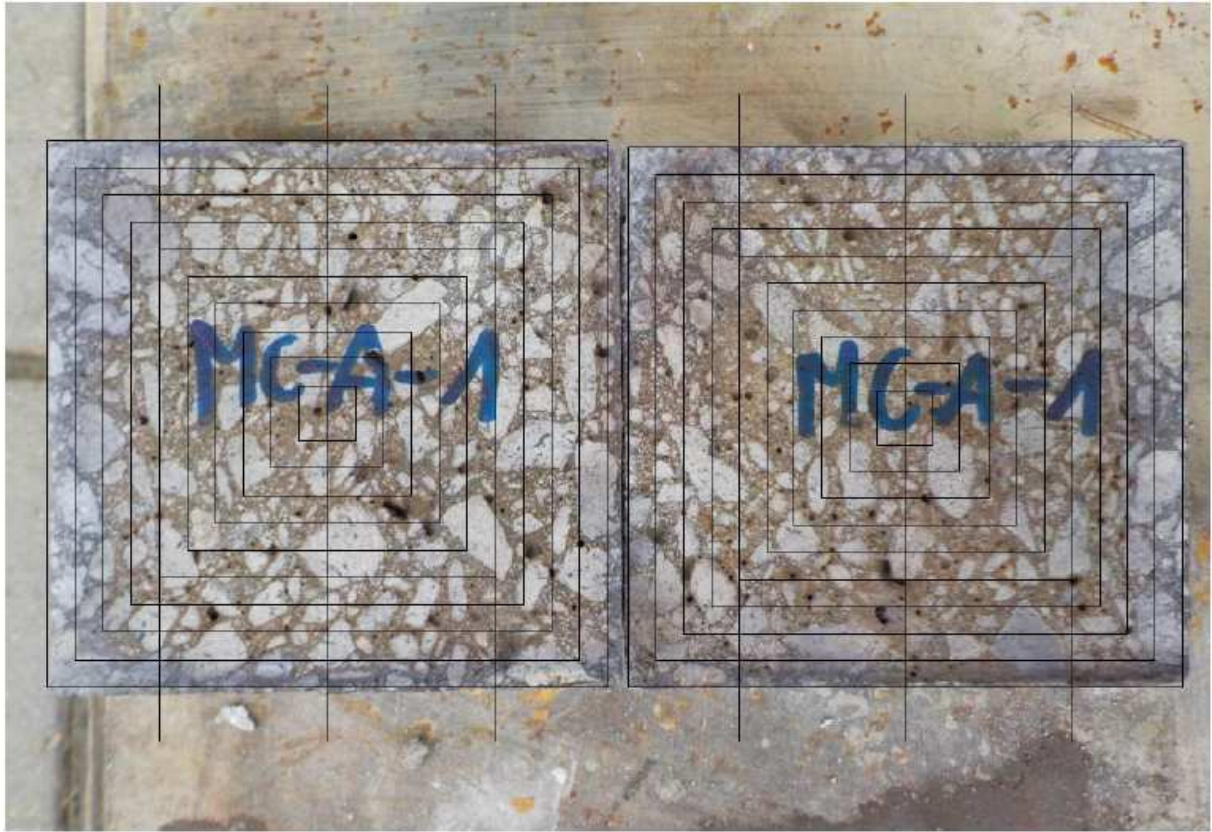
Rysunek 6. Zdjęcie próbek po badaniu głębokości wnikania chlorków [125]
